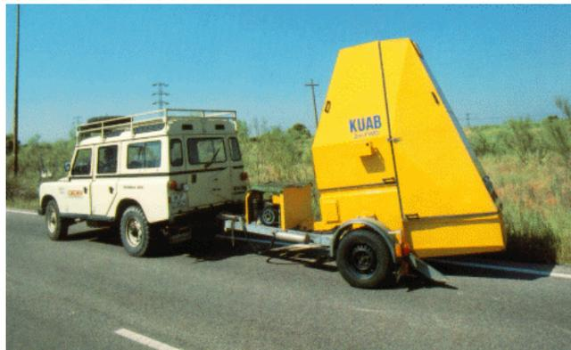
Equipo constituido por una masa que se deja caer por gravedad, desde una altura determinada, sobre una placa, provista de un sistema de distribución, que transmite la carga de manera uniforme a la superficie sobre la que se apoya.
