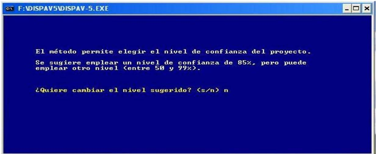
Pantalla mostrada por el DisPav, para la introducción del nivel de confianza considerado en el diseño del pavimento.
