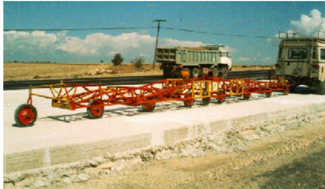
Equipo de medida de tipo geométrico de la regularidad superficial de un firme de carretera.
