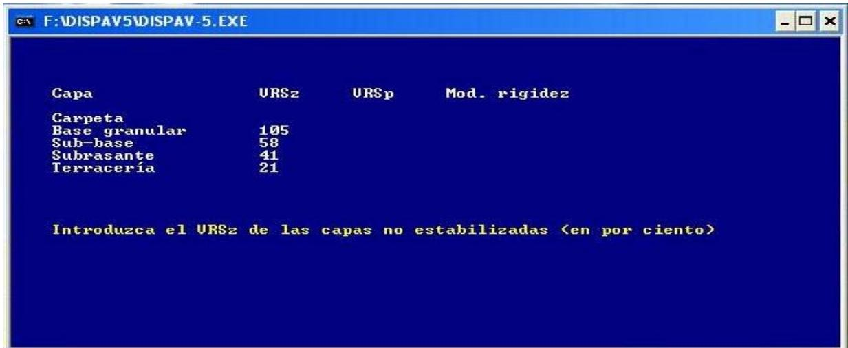
Imagen mostrada por el DisPav, para la introducción de los VRSz de las capas no estabilizadas con asfalto.
