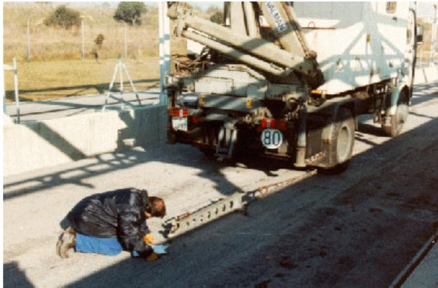
Deflectómetro mecánico simple. Una palanca suspendida de un bastidor, transmite la deflexión vertical del punto de medida a un comparador.
