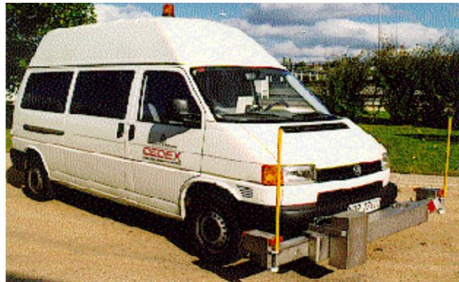
El perfilógrafo es un equipo preparado para registrar los perfiles longitudinales y transversales de las carreteras, así como la textura de las mismas. Está montado en un vehículo, modelo Transporte Combi.
