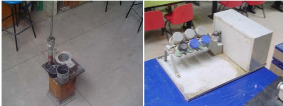
*Conjunto para prueba Marshall    Dispositivo para adherencia*
