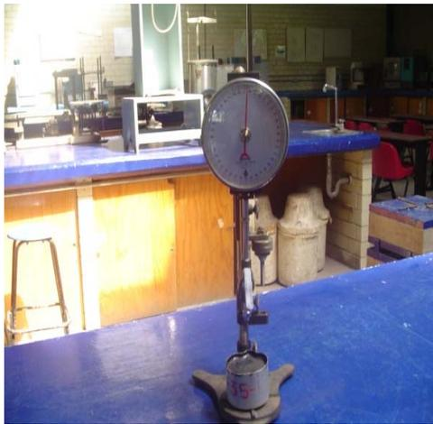
*Penetrómetro de asfaltos*
