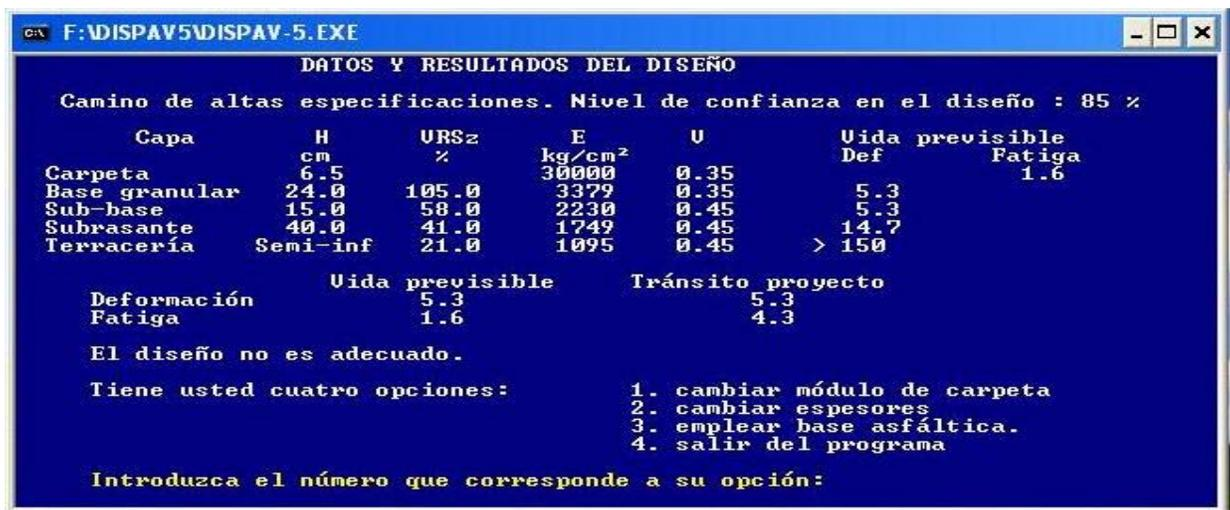
Ventana mostrada por el DisPav, con los resultados del diseño anterior y los datos utilizados para el diseño por deformación.
